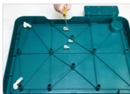
ガイドリングを同じ方向にネジで固定させます。
