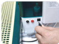
センサージャックを接続した後、背面で電源ジャックを接続します。
